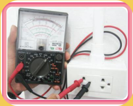
แสดงการใช้มัลติมิเตอร์วัดแรงดันไฟฟ้าระหว่างไลน์กับสายดิน
