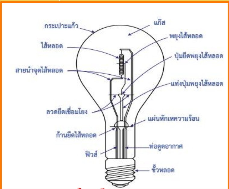
โครงสร้างของหลอดอินแคนเดสเซนต์ธรรมดา
