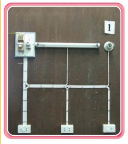
ตัวอย่างการเดินสายด้วย เข็มขัดรัดสาย
