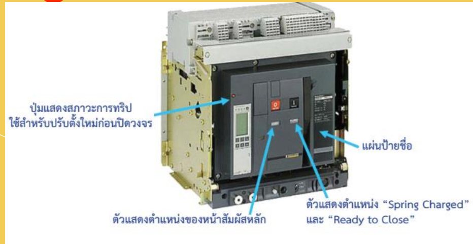
(ก) โครงสร้างของแอร์เซอร์กิตเบรกเกอร์แบบดึงออกได้
