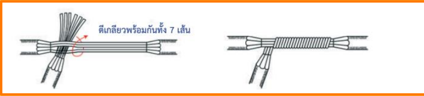
การต่อสายไฟฟ้าแบบ Y Splice
