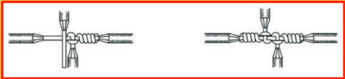
การต่อสายไฟฟ้าแบบแยก 2 ทาง
