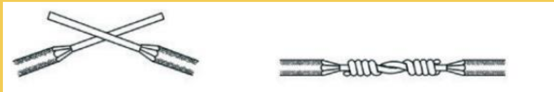
การต่อสาย 60227 IEC 01 แบบต่อตรง
