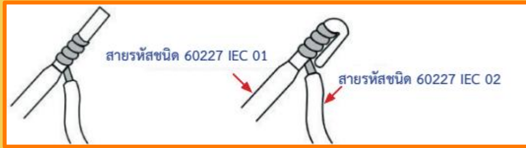
การต่อสายไฟฟ้าอ่อนเข้ากับสายไฟฟ้าแข็ง
