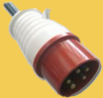
(ค) เต้าเสียบ 3 เฟส 5 ขั้ว (3P+N+PE)
