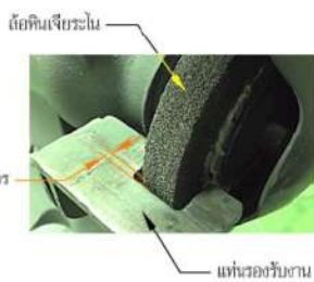
รูปที่ 4. การปรับระยะห่างของล้อหินเจียรไนกับแท่นรองรับงาน
