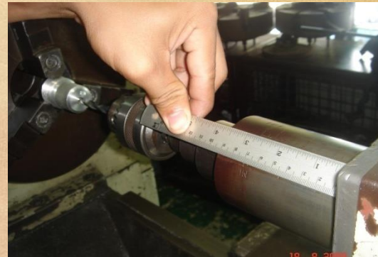
การใช้บรรทัดเหล็ก วัดระยะเจาะรูด้วยดอกสว่าน
