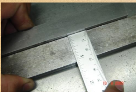
การนำเหล็กแท่งขนานมาทำ เป็นปากชนในการวัด
